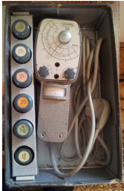
Izgled tvorničkog Grid dip metra GRUNDIG sa elektronskom cijevi, triodom EC92 i setom zavojnica
