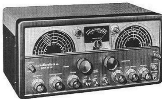
Slika 5. – Telekomunikacijski prijmnik SX-100 američke tvrtke Hallicrafters iz 1960-ih godina
