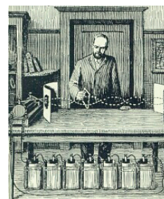
Slika 1.20. Heinrich Hertz (1857. - 1894.), otkrivač radiovalova. Na slici Hertz eksperimentira u svome laboratoriju (crtež): lijevo je odašiljač (induktor s iskrištem), a desno reflektorska ploča. U ruci drži žičani okvir s prorezom. Jedinica za frekvenciju danas je hertz (Hz).
