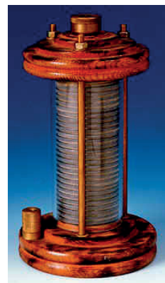
Slika 1.10. Voltin stup sastojao se od naslaganih kolutića bakra, namočenoga kartona u elektrolitu i cinka. Davao je napon do tridesetak volta.
