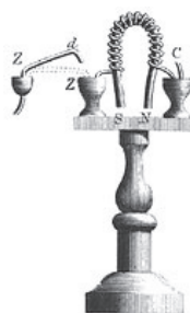
Slika 1.13. Englez William Sturgeon (1783.-1850.) načinio je prvi elektromagnet. Mogao je podići čak 4 kilograma željeza. Na slici je originalni Sturgeonov crtež.
